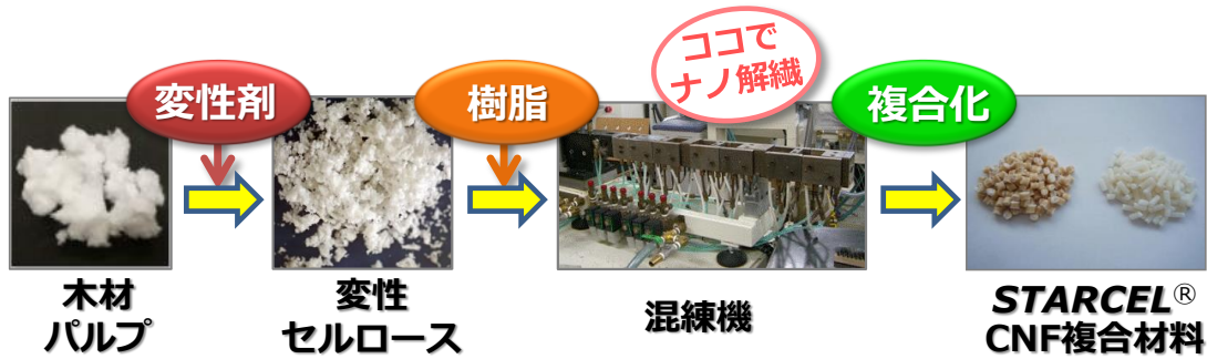
図 1. 変性 CNF 配合樹脂 STARCEL® の製造フロー
