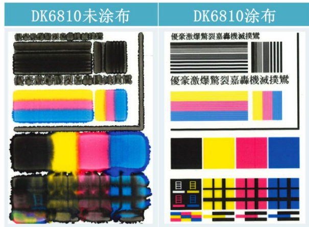
图 10. 薄膜喷墨打印效果
